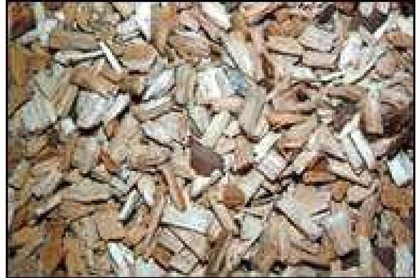
Das Material muss gehackt sein, da bei geschredderter Ware nicht gewährleistet ist, dass die notwendige Menge in vollem Umfang aus dem Bunker zum Kessel befördert werden kann.
